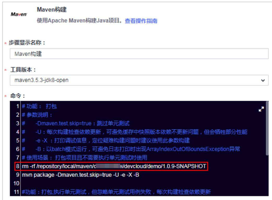
**步骤4** 重新执行构建任务，执行成功后按照上面步骤再次编辑任务，移除清理缓存命令。
